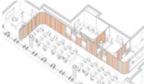
شكل (1) نظام الفواصل المنزلقة يسمح بزيادة المساحات الداخلية للفراغات وإعادة تقسيمها حسب الحاجة.
